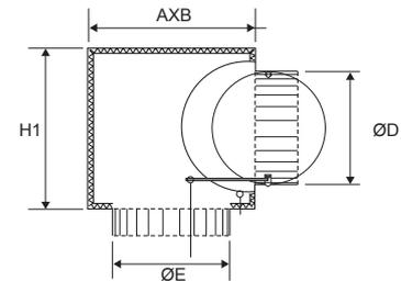
Plenum isolato esternamente a norma UNI ENV12097/1999 in polietilene adesivo sp. 6 mm.
