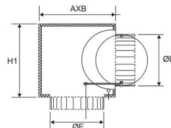
Plenum isolato esternamente a norma UNI ENV12097/1999 in polietilene adesivo sp. 6 mm.
