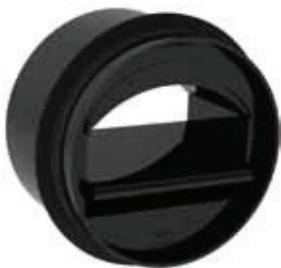
Regolatore di portata costante circolare con manicotto in PVC (acciaio zincato a partire da 250 mm), sistema autoregolabile in PVC composto da una pala, una molla ed un pistone ammortizzatore. Mantiene una portata costante per una variazione di pressione da 50 a 200 Pa.
