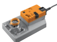
GM per serrande fino a 8 m 2 40 Nm
